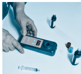
残留塩素チェッカーと薬品を用いて水道水を検査する様子
