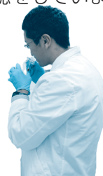
水道水の臭いを確認する様子
